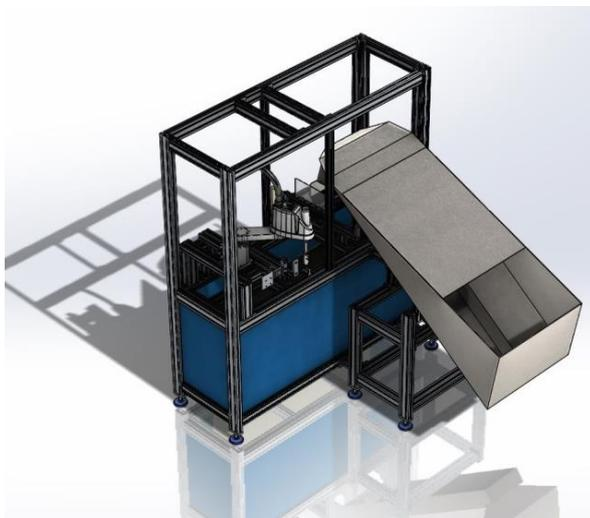
Caricatore automatico di manici con Robot e sistema di visione. Tramoggia di carico in acciaio inox da 200 lt. Produttività oraria 1500 pezzi. Possibilità di assistenza in remoto.
